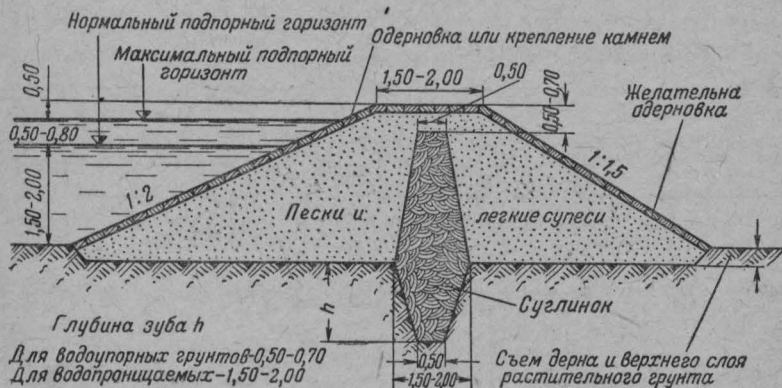
Рис. 113. Поперечное сечение земляной плотины из водопроницаемых грунтов с вертикальным глинистым ядром
